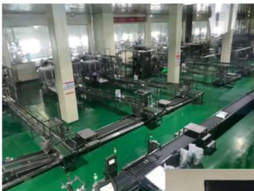
岱岳制盐公司生产网自动化生产线 [ 岱岳制盐公司工艺采用国际先进的六效真空制盐技术，更加节能环保与安全环保。地下岩盐融化后的卤水进入制盐车间后，进行循环蒸发，均在密闭管道中进行，不与外界接触，保证了食盐安全卫生。同时，公司制盐生产采用 DCS 自动化控制系统，把食盐输送、包装计量、加碘数据等参数引入系统，实现了全过程自动化监控。]
